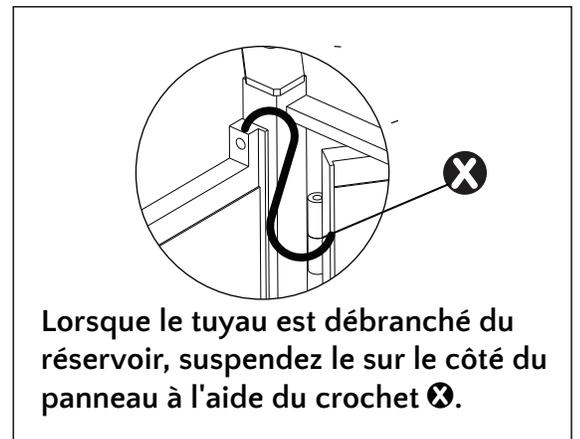
Lorsque le tuyau est débranché du réservoir, suspendez le sur le côté du panneau à l'aide du crochet **X**.
